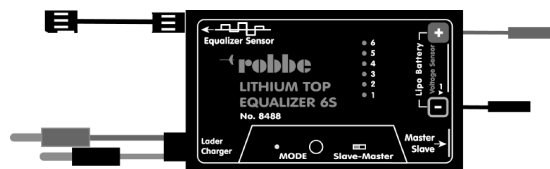
Ecualizador TOP 6S litio No. 8488 para packs 2-6S, en cascada a través de una conexión Master-Slave a 2x6S = 12S
