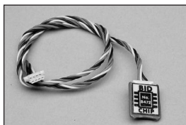
Chip BID con cavo da 300 mm per equipaggiare altre batterie Art.N. 8473
