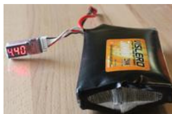
Ein angeschlossener LipoTester zeigt eine Spannung von 4,4V pro Zelle - Maximal zulässig ist 4,22V
