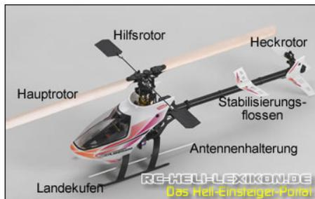
Komponenten welche zur Erzeugung von Steuerbewegungen, Vorwärts- und Hubkraft notwendig sind. Eigentlich muss man nicht erwähnen, dass dieses Bauteil ein technisches Highlight darstellt.
