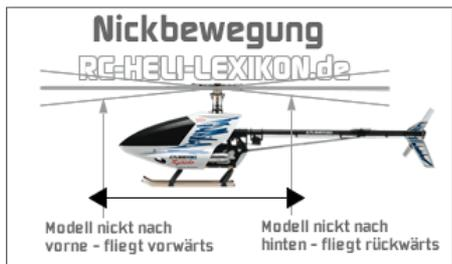
Die Taumelscheibe wird bei der Nicksteuerung regelrecht nach vorne oder nach hinten gekippt. Dadurch fliegt unser Heli entweder nach vorne oder nach hinten (scheint ja auch logisch, oder?). Noch mehr ins technische Detail: Die Nickanlenkgestänge werden so verschoben, dass die Taumelscheibe nach vorne oder eben nach hinten gekippt wird. Das hat zur Folge, dass die Paddelebene - die sogenannten Hilfsrotorebene - und die Hauptrotorblätter so angesteuert werden, dass der Auftrieb der Hauptrotoren
