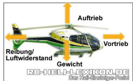
Ein Heli wird oft auch als Drehflügler bezeichnet. Warum? Bei einem Flächenflugzeug sind die Flügel (Tragflächen) starr montiert. Beim Heli sind sie drehbar gelagert - erinnern sie sich an ein paar Zeilen weiter oben Einstell- und Anstellwinkel?!. Durch den Motor werden diese "Flügel" in eine schnelle Drehung versetzt, durch die nun anströmende Luft wird der Auftrieb erzeugt.
