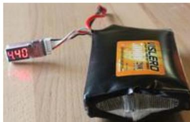
Ein angeschlossener LipoTester zeigt eine Spannung von 4,4V pro Zelle - Maximal zulässig ist 4,22V
